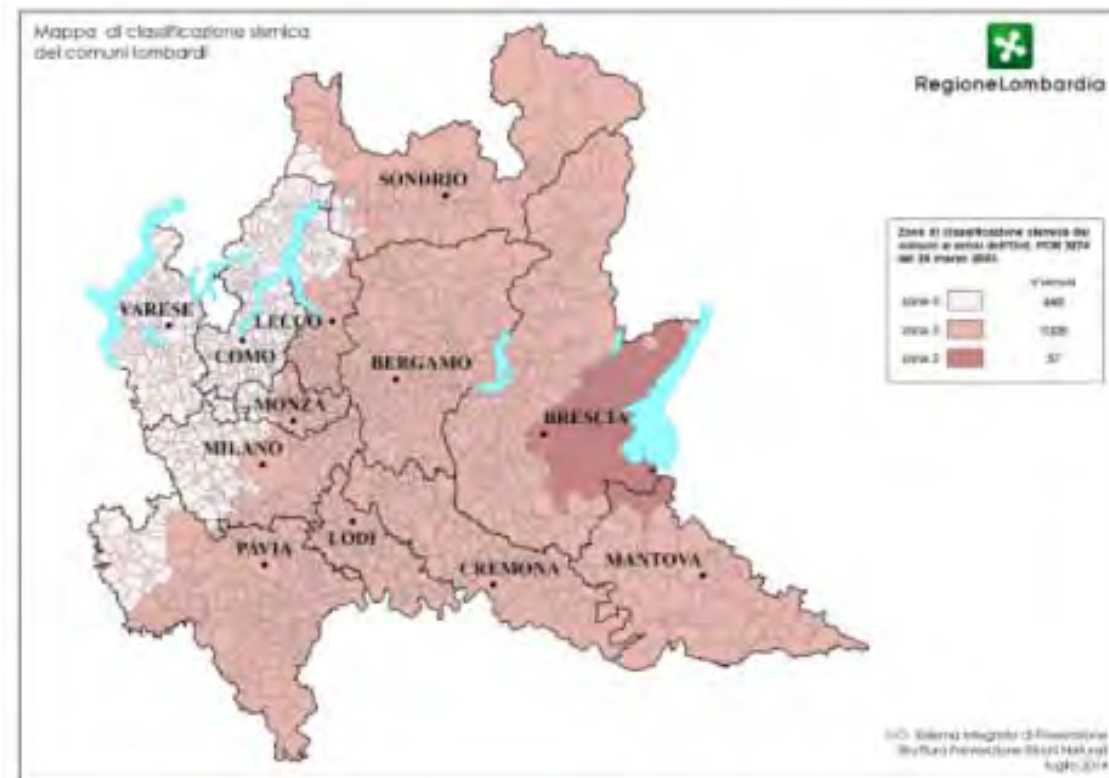
Mappa di classificazione sismica dei comuni lombardi (DGR n. X – 5001 del 30 marzo 2016)
